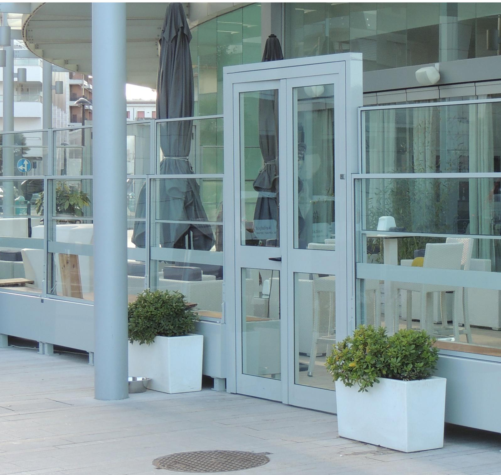
Las puertas han sido diseñadas para poder brindar protección del aire, el agua y el viento. Están realizadas con perfiles extruidos en aleación de aluminio (EN-AW 6060-T6) y vidrio estratificado blindado para prevenir accidentes 4+4 PVD 0,76 de conformidad según la UNI 7697 2014. Las puertas están disponibles en la versión de una hoja o de dos hojas.
