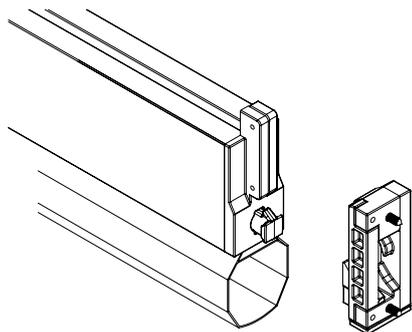
WIND BLOCK: Sistema de bloqueo automático del terminal aplicable a los Screeny 110 y 130 con guía GPZ C, GPZ I y GPZ Unica. Bajo la acción del viento el terminal se bloquea en la posición baja y el tejido, con el toldo completamente abierto, está constantemente tensionado. permite escoger la mejor solución y la que mejor se adapte a cada ambiente.
