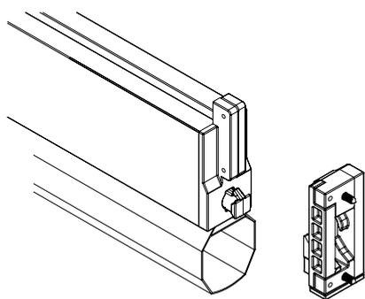
WIND BLOCK: Automatisches Blockier System des Ausfallprofils an der Screeny 110 und 130 mit Führungsschiene GPZ C, GPZ und GPZ Unica. Unter Windeinwirkung wird das Ausfallprofil in der unteren Position blockiert, und das Tuch bei vollständig offener Markise gespannt.
