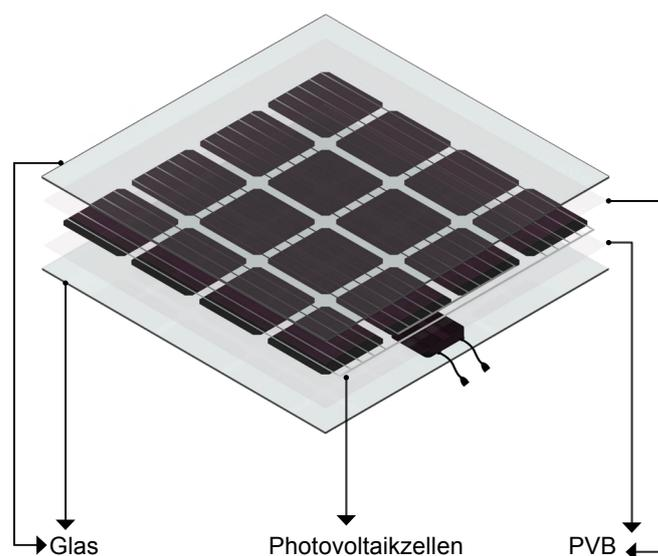
Sunlight bietet dank der Vielseitigkeit des Produkts eine innovative Lösung für die nachhaltige Energieerzeugung: mit der Integration von Photovoltaik-Verbundglas in das Dach. Die Photovoltaikzellen von Sunlight sind strategisch in einem Gittermuster angeordnet, um die verfügbare Fläche optimal zu nutzen. In einer Konfiguration von 6 x 4,5 Metern ist Sunlight in der Lage, eine beachtliche Leistung von 1,4 kW zu erzeugen.
